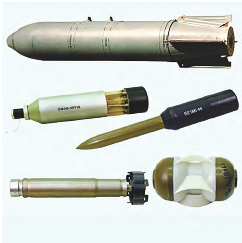
Рис. 3. Советская разовая бомбовая кассета и ее суббоеприпасы различного назначения
