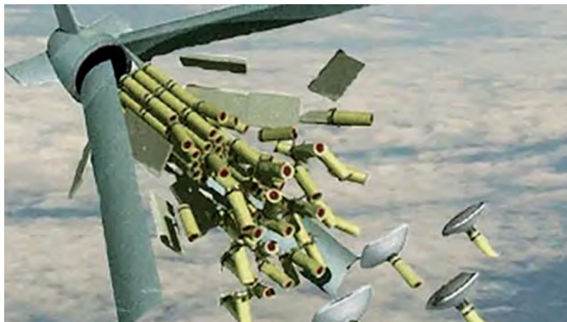
Рис. 1. Высвобождение суббоеприпасов из разовой бомбовой кассеты
