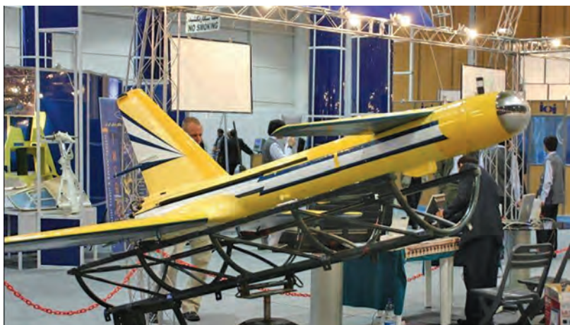
Рис. 6. БПЛА модификации «Абабиль-2Р» с электрооптической камерой в носовой части
