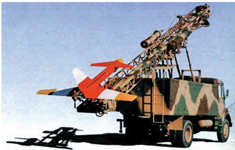
Рис. 10. Пневматическая система пуска БЛА «Абабиль-2» с пневматической катапультой типа PL3 на кузова грузового автомобиля
