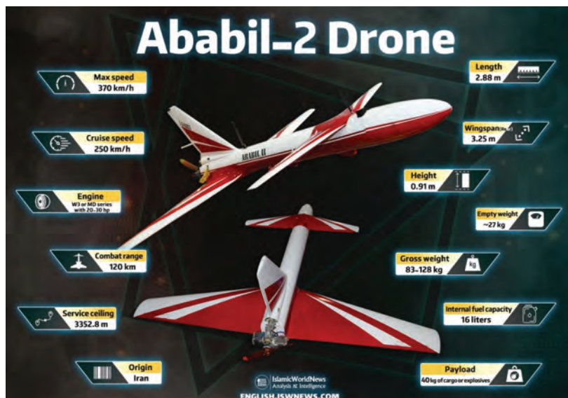
Рис. 2. Внешний вид и основные летно-технические характеристики дрона «Абабиль-2Б»
