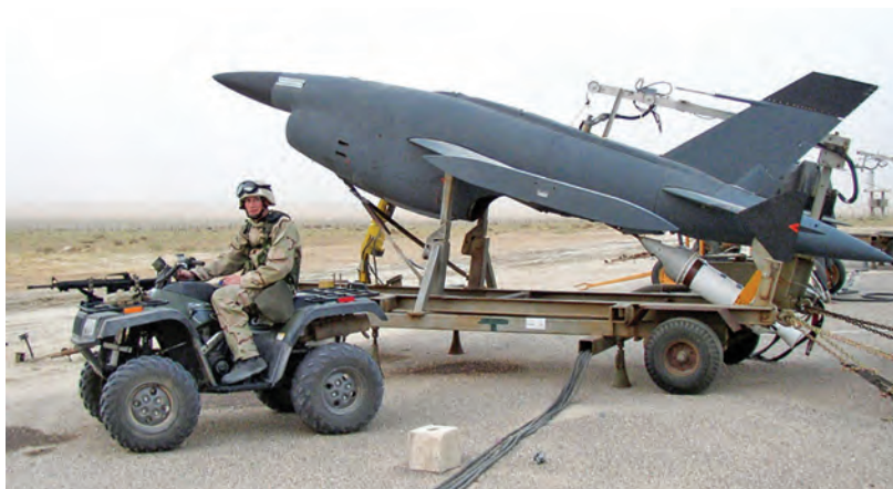
Рис. 1. Американская авиационная мишень BQM-34 Firebee массой 935 кг с турбореактивным двигателем ТРД Continental J69-T-29
