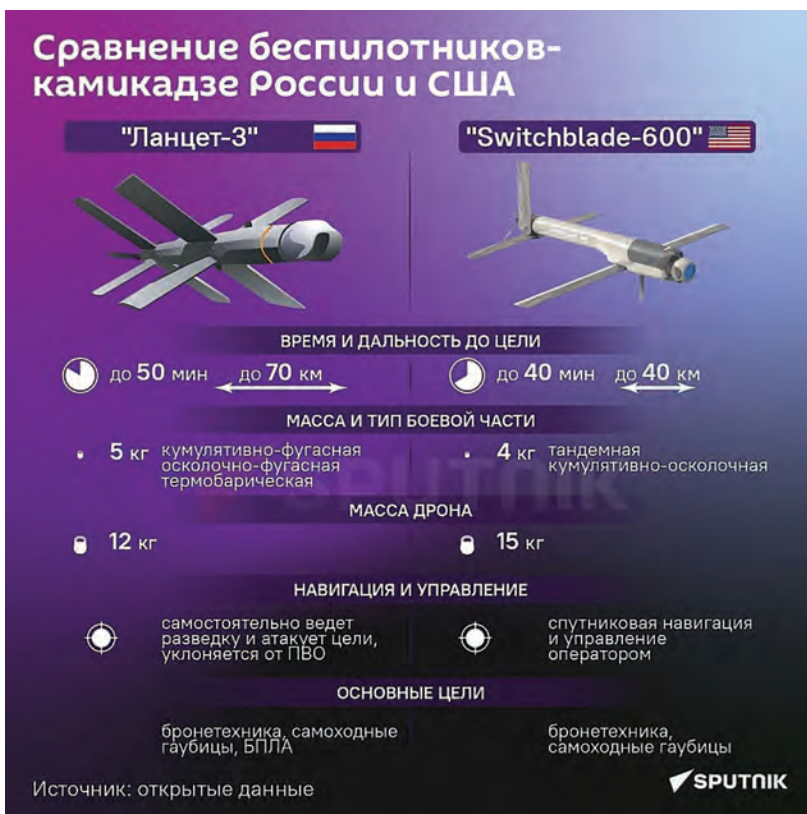
Рис. 14. Российский ББП «Ланцет-3» (а) и его ТТХ в сравнении с ТТХ американского ББП Switchblade 600(б)
